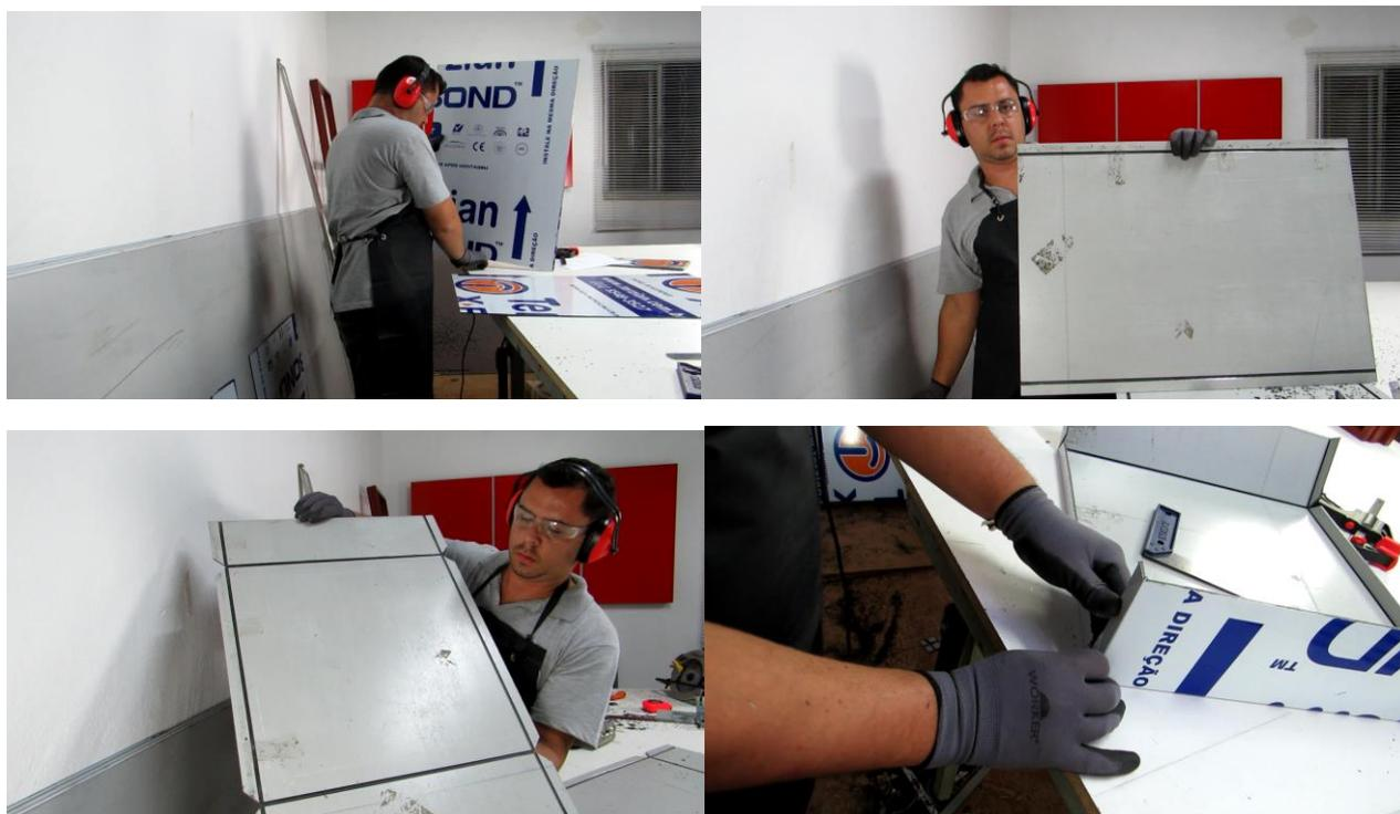
Esta técnica consiste basicamente em dobrar as bordas do painel, transformando-a em uma bandeja.
