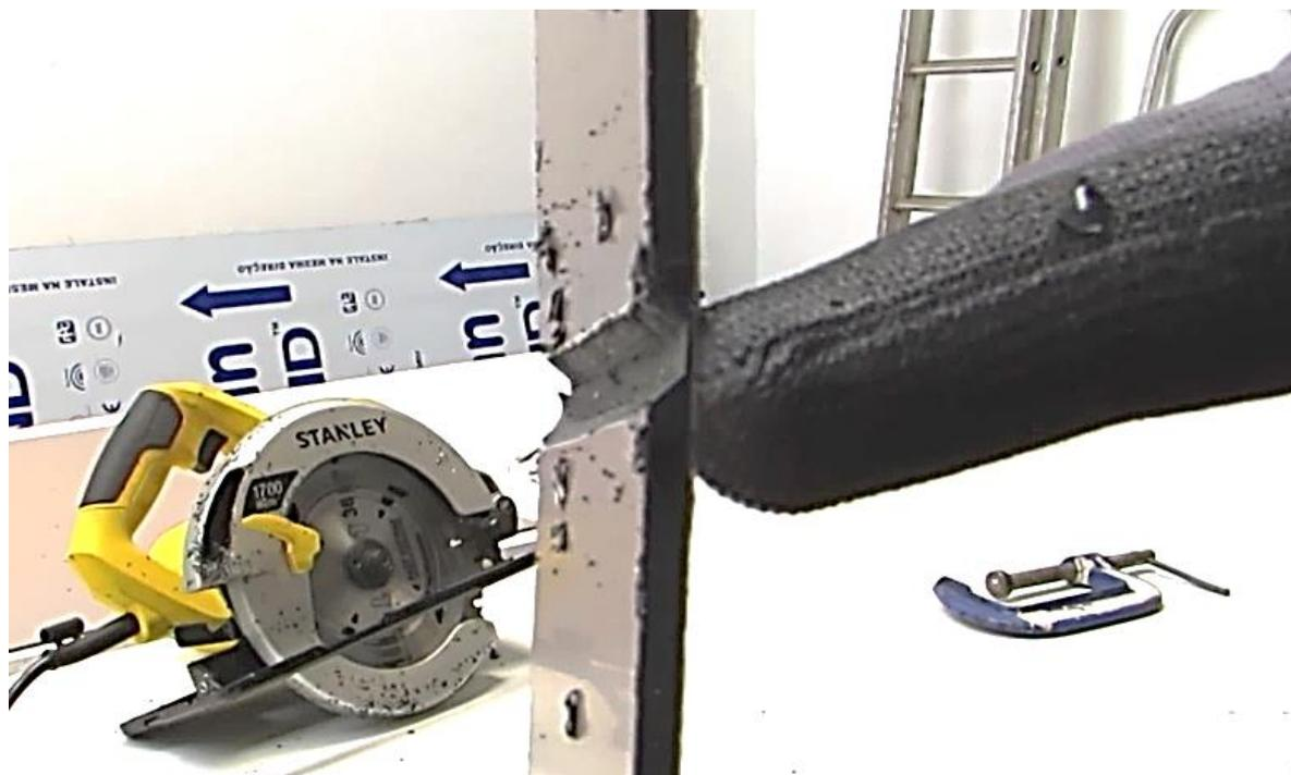
Base da cavidade (espessura mínima de polietileno + espessura da chapa de alumínio).
