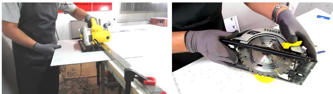
A serra circular equipada com discos de vídea é uma excelente ferramenta para corte precisos e com excelente acabamento.
