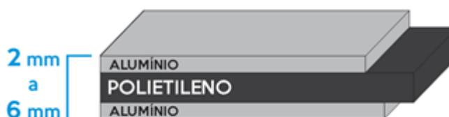
As lâminas de alumínio também possuem variação, podendo ser encontradas nas espessuras de 0,15mm, 0,18mm, 0,21mm, 0,30mm e 0,50mm. Quanto mais espessa a lâmina de alumínio, mais resistência e de maior durabilidade será a chapa.
